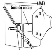
10. Girar el pasador de empuje de manera que se encuentre en el mismo ángulo que el agujero cuadrado en la parte trasera de la caja del cerrojo (Ilustración 8). Deslizar la caja del cerrojo por encima del pasador de empuje. Colocar en posición la caja del cerrojo de manera que el pasador de empuje se encuentre en el centro del agujero a través del poste (Ilustración 7). No dejar que el pasador de empuje roce contra el borde del agujero porque podría impedir el funcionamiento.
